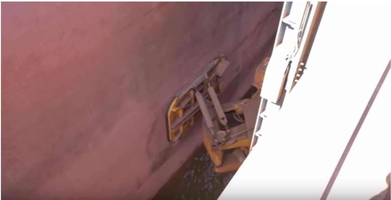
Figur 3-10: Illustrasjon av tilkoblingsenhet som kan møte skrogvinkelen til skipet
