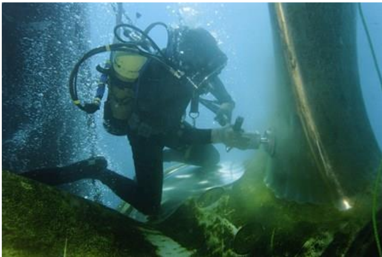
Figur 3-8: Dykker som utfører propellpolering under et havneligge
